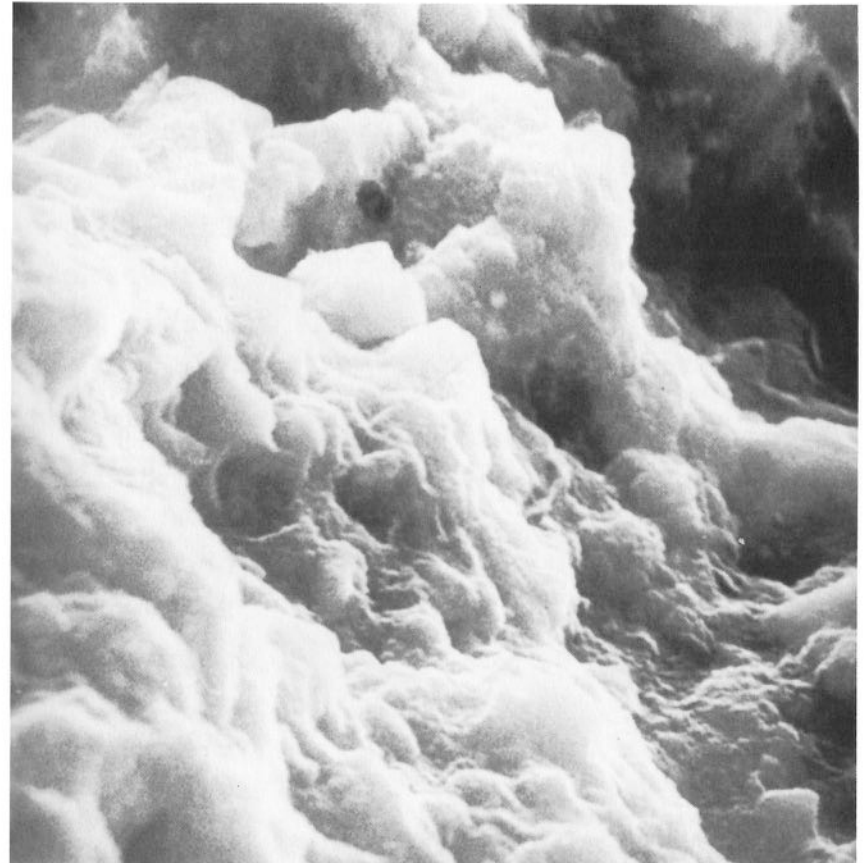
Rasterelektronenmikroskopaufnahme von der Steinoberfläche (15 000-fach vergrößert)
