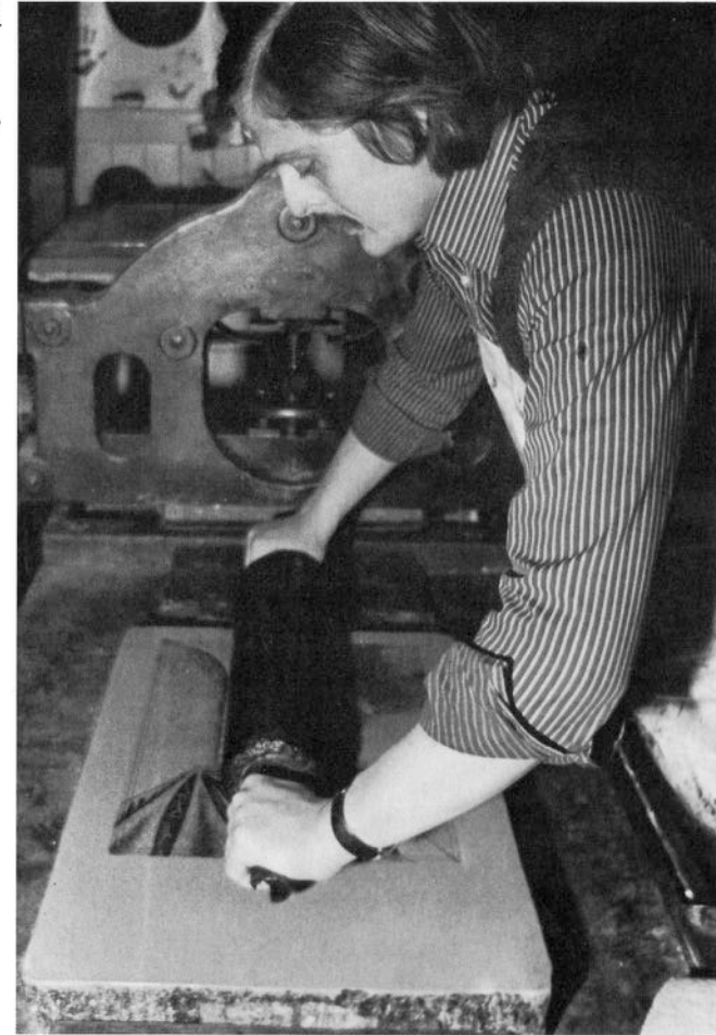
Die Walze wird mit federnden Handgelenken geführt.
