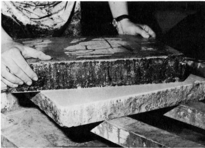
Durch das Steineschleifen von Hand erhält man eine völlig ebene Oberfläche.
