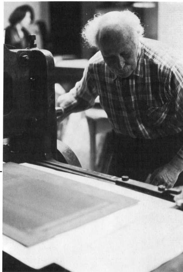
Beim Durchkurbeln gibt der Reiber über ein Blech den Druck gleichmäßig an den Stein ab.
