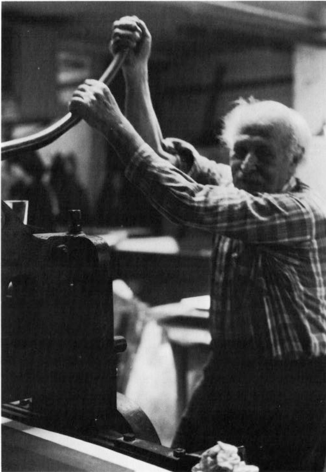
Der Druck einer Kniehebel- presse erzeugt bis zu 18 Tonnen Druck auf dem Stein.
